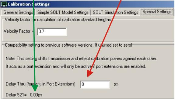
Wenn Sie einen leeren weibl. Thru Adapter (ohne Mittelverbinder und Tefloneinsatz) verwenden, wird der SMA männl. Mittelverbinder als Openstandard verwendet. Der Wert des Delays ist sehr klein:  $2 \times -5.0\text{ps} = -10\text{ps}$
