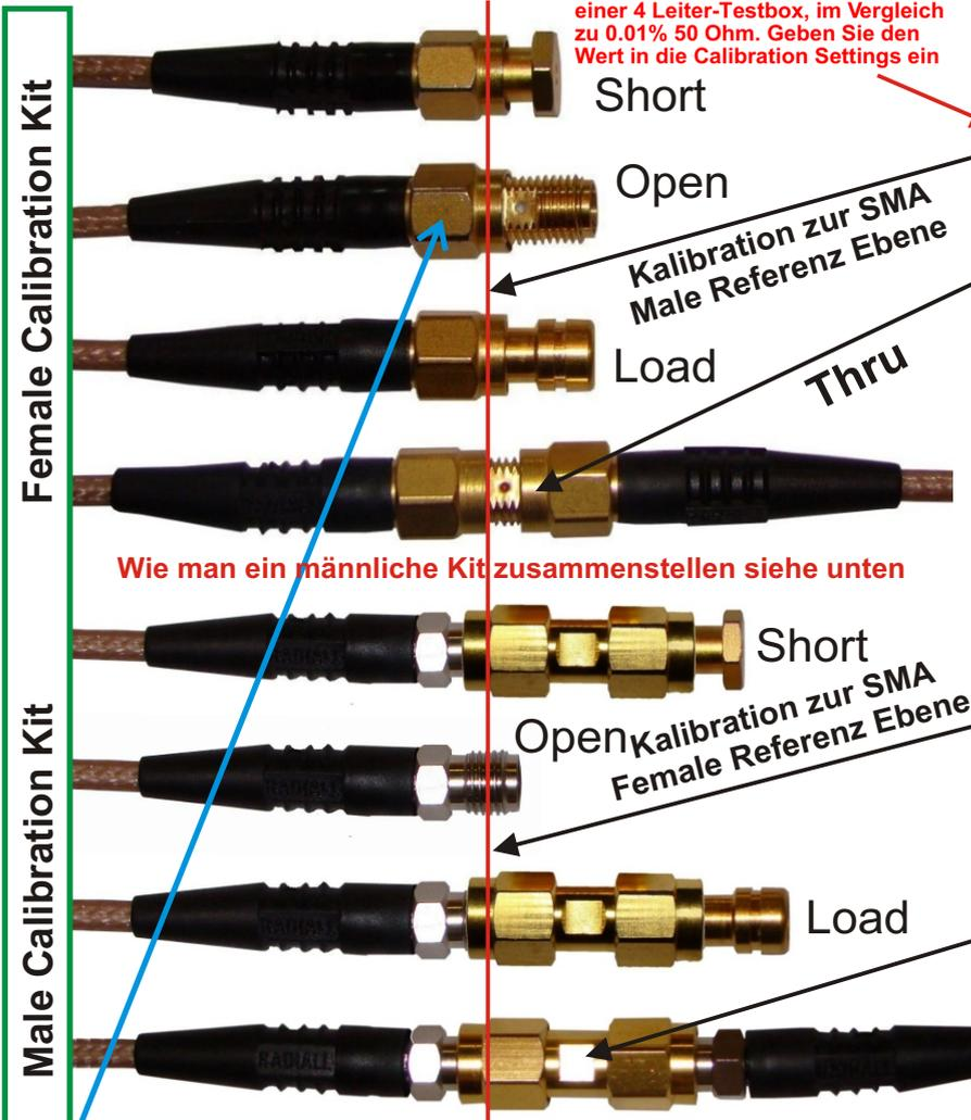
Der DC-Widerstandswert des Load wurde von SDR-Kits gemessen mit einer 4 Leiter-Testbox, im Vergleich zu 0.01% 50 Ohm. Geben Sie den Wert in die Calibration Settings ein
