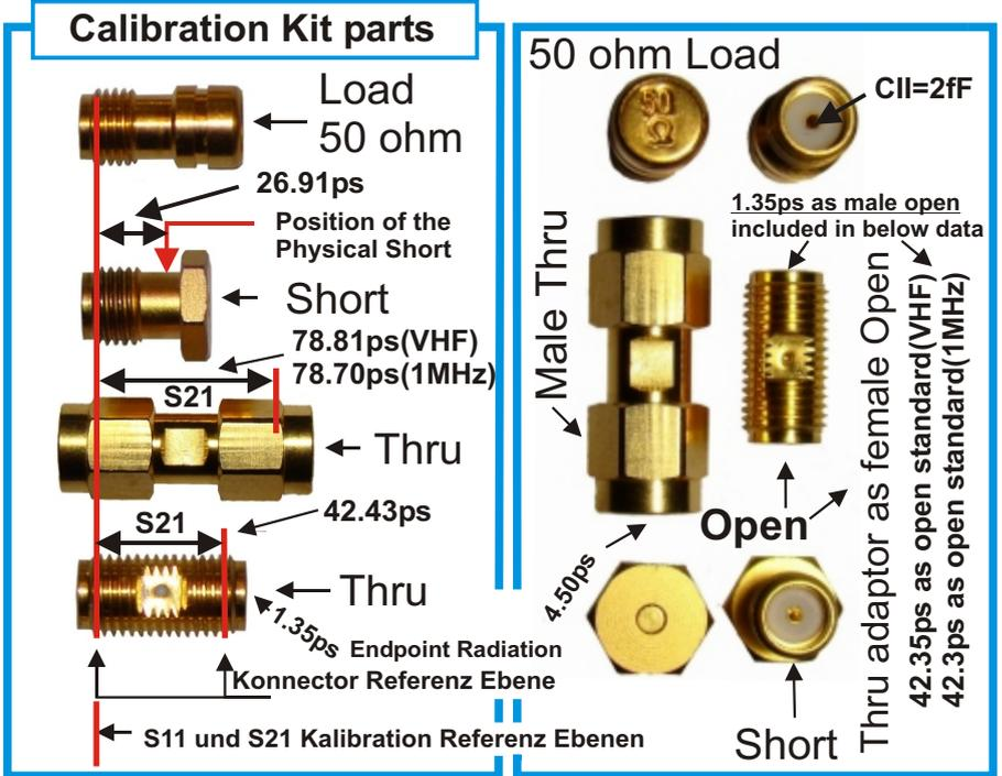
Auf dieser Seite finden Sie die benötigten Einstellungen in "Calibration Settings" und "Simple SOLT" für die Reflektions (S11/S22) und Transmissions (S21/S12) Kalibrierung.
